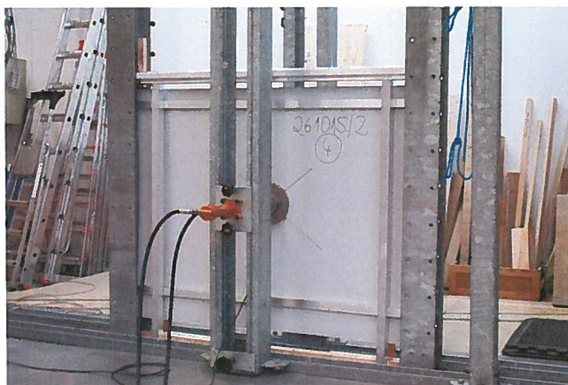
Abbildung 2: Prüfaufbau Biegeprüfung Variante 2
